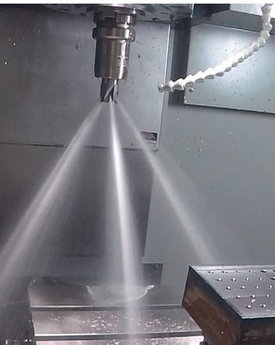
**Validierung:** Ob der Kühlmittel- und Spänefluss wirklich optimal ist, wird in Praxistests überprüft.
